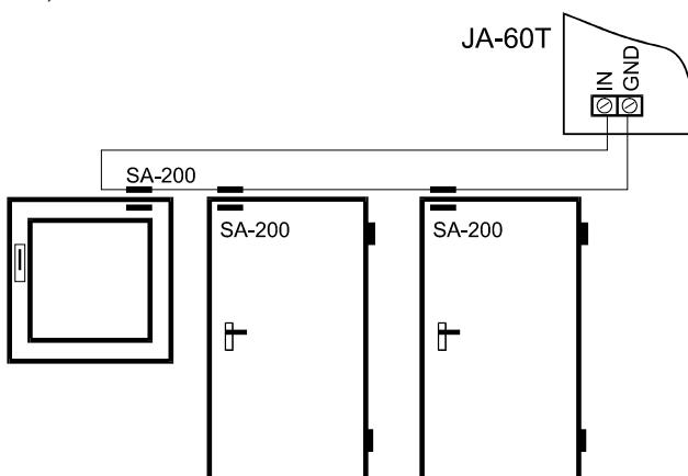
Pokud připojujete více než jeden snímač, zapojte je do série. Signál ze vstupu IN lze pomocí propojky K2 adresovat do vybrané zóny ústředny (INST, DELAY, FIRE, PANIC).
